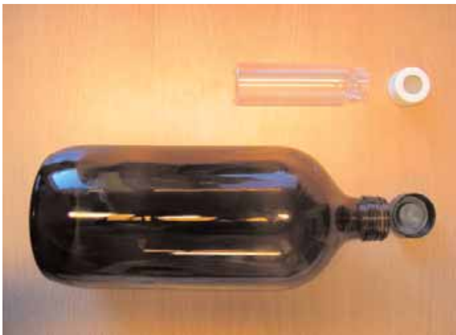
Figura 3.41 - Diverse tipologie di contenitori per campionamento di matrici ambientali: fiala da 20 cc con setto siliconico per il campionamento di terreno o acqua per analisi di composti volatili; bottiglia da 1 litro in vetro scuro per campionamento di acqua
