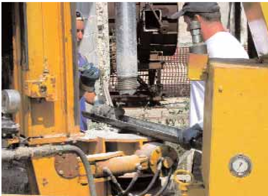
Figura 2.9 - Estrazione a secco da un carotiere semplice. Una volta estratto dal foro di sondaggio, il carotiere viene percosso con un martello mentre è tenuto sospeso in verticale dalla fune di manovra della trivella e la carota, cadendo per effetto della gravità, viene raccolta in un alloggiamento concavo prima di essere adagiata nella cassetta catalogatrice
