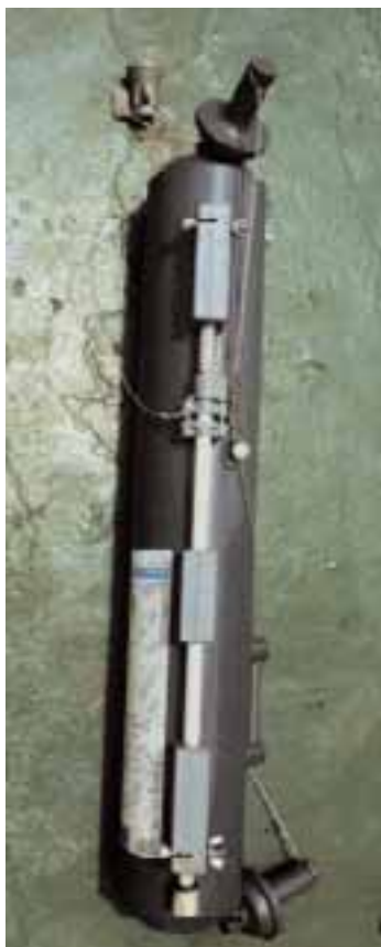
Figura 4.7 - Bottiglia Niskin per il campionamento in profondità delle acque di laghi, mari, lagune. Una volta posizionata la bottiglia alla profondità desiderata, si lascia partire dalla superficie un messaggero (un peso di qualche etto) che corre lungo il cavo cui è ancorato il corpo della bottiglia. Il messaggero, colpendolo, apre un anello liberando i tappi posti all'estremità della bottiglia che sono richiamati in posizione di chiusura da una molla (o elastico). Nella apertura dell'anello può anche essere liberato un secondo messaggero che può raggiungere un'altra bottiglia posta a maggiore profondità, determinandone la chiusura
