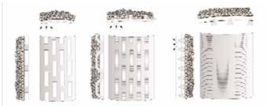
Figura 3.8 - Particolare degli "slot" della parte finestrata di un piezometro
