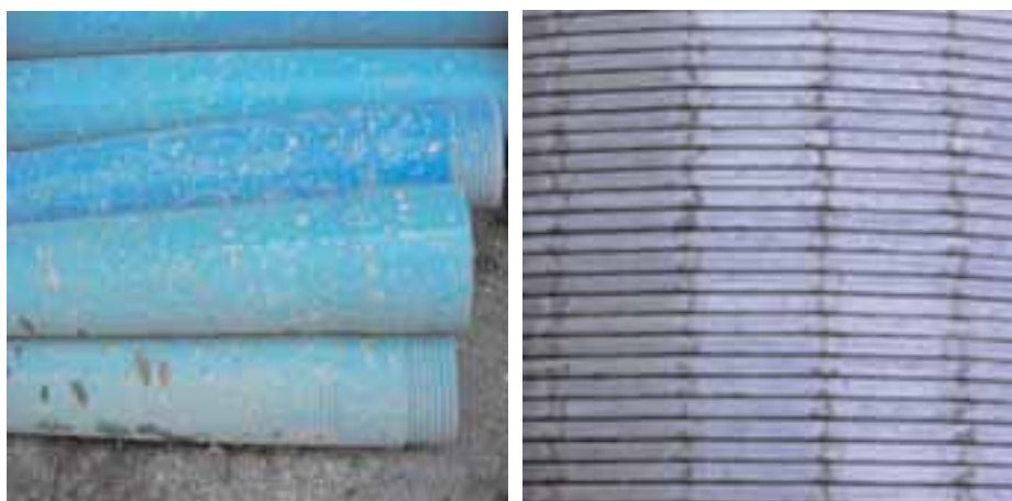
Figura 3.9 (a sinistra) - Tubi in PVC fessurati
