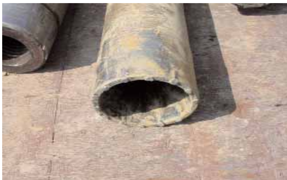
Figura 2.8 - Particolare di corona con denti al widia (carburo di tungsteno) montata su carotiere semplice dal diametro di 101 mm
