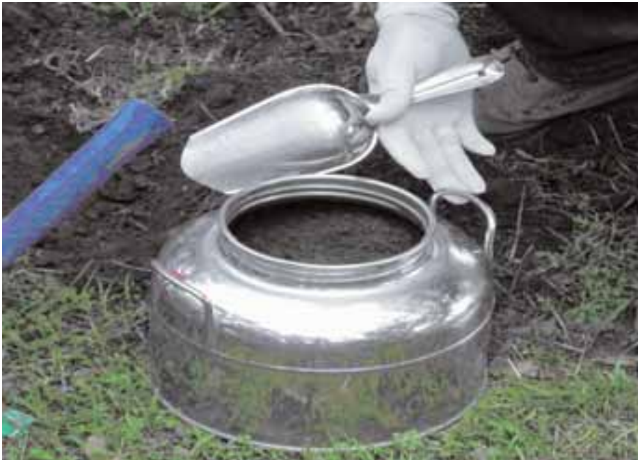
Figura 7.7 - Procedure di omogeneizzazione dei campioni di terreno per la preparazione di duplicati
