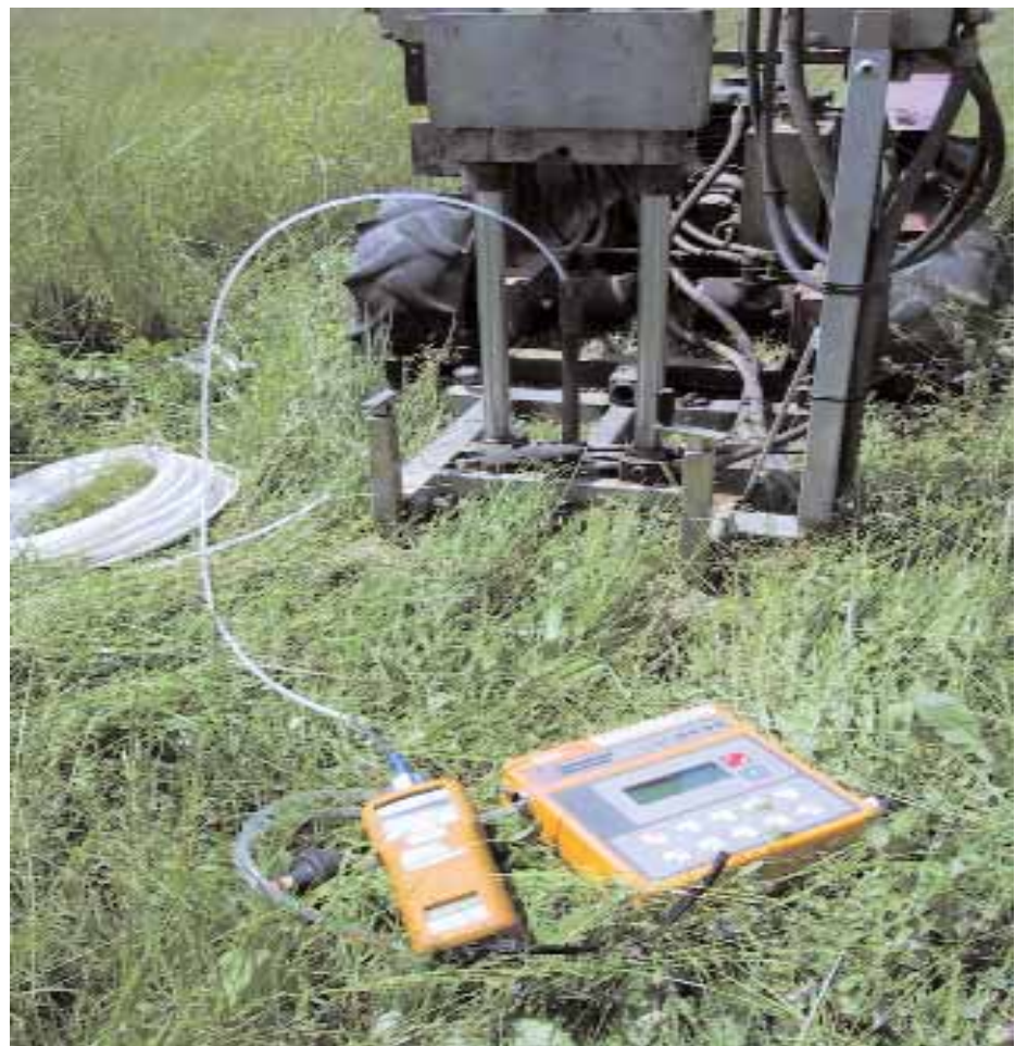
Figura 1.15 - Misura in campo dei gas interstiziali mediante collegamento diretto dello strumento portatile alla sonda precedentemente infissa mediante sistema meccanico
