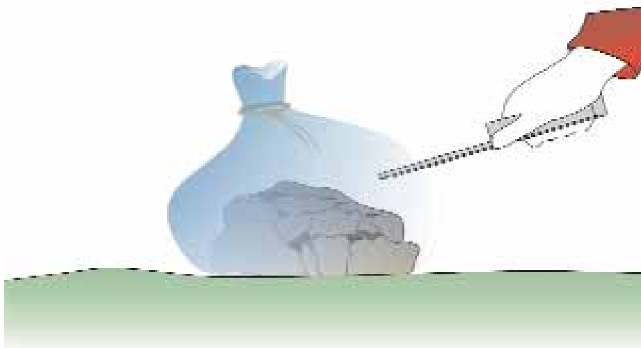
Figura 2.24 - Analisi dello spazio di testa in campo. Appena prelevato, il terreno è messo in una busta di plastica. Trascorso qualche minuto, la cannula di aspirazione del PID viene inserita nella busta consentendo di effettuare una misura "semiquantitativa" dei COV rilasciati dal terreno nello spazio di testa
