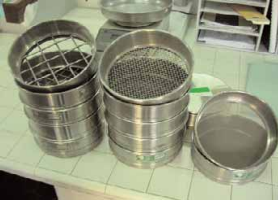
Figura 2.26 - Setacci utilizzati per la determinazione della curva granulometrica del campione. I setacci vengono impilati in ordine decrescente (le maglie più larghe sopra, quelle più strette verso il basso) e sistemate su una piastra vibrante. Il terreno viene quindi suddiviso nelle diverse frazioni e pesato. Il rapporto fra peso dell'aliquota di terreno trattenuto in ogni setaccio e il peso totale del campione, espresso in percentuale viene riportato sulla curva granulometrica
