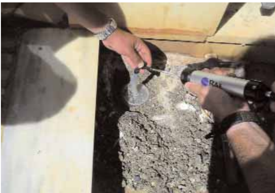
Figura 1.5 - Una semplice pompa a mano consente di far fluire una quantità nota di gas campione attraverso una fiala colorimetrica (vedi figura 1.14). Ognuna di queste fiale è specifica per un parametro in un determinato range. L'esito dell'analisi è immediatamente leggibile sulla scala graduata della fiala
