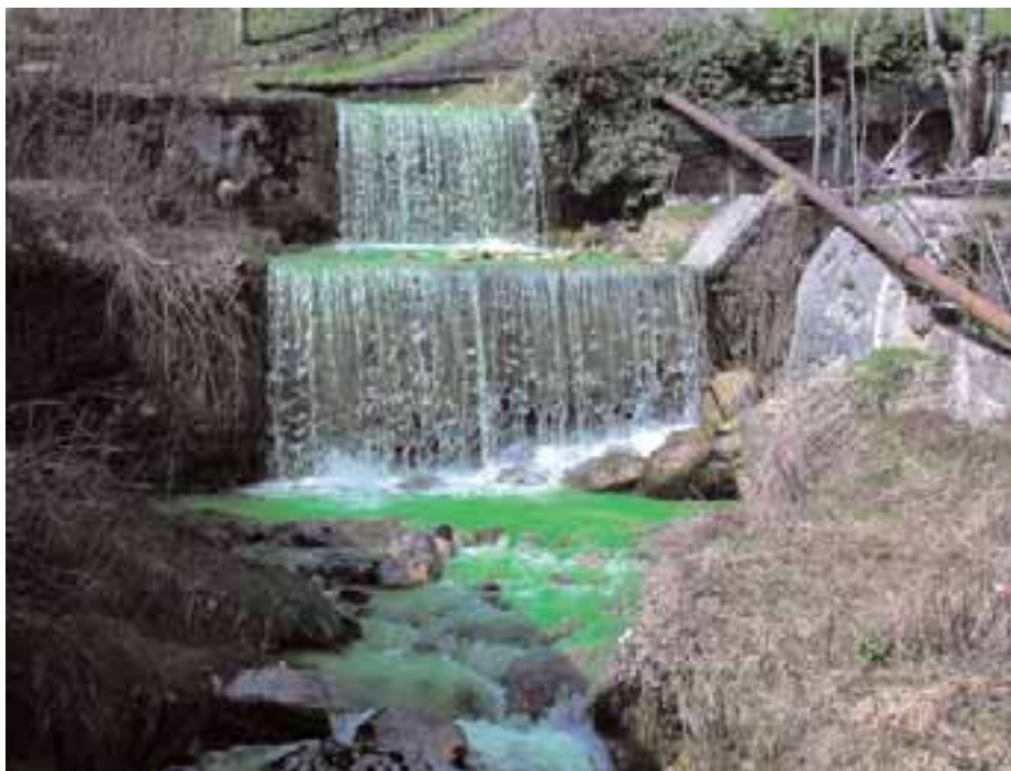
Figura 4.6 - L'immissione di traccianti colorati in un corpo idrico permette di determinarne facilmente le velocità di scorrimento. Questo dato può essere importante quando si ricercano dei composti instabili
