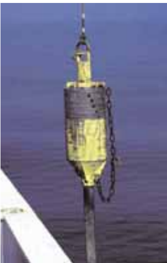
Figura 5.8 - Discesa in acqua di un carotiere a gravità (in alto). Il carotiere è in grado di campionare anche diversi metri di sedimento non perturbato dal punto di vista stratigrafico
