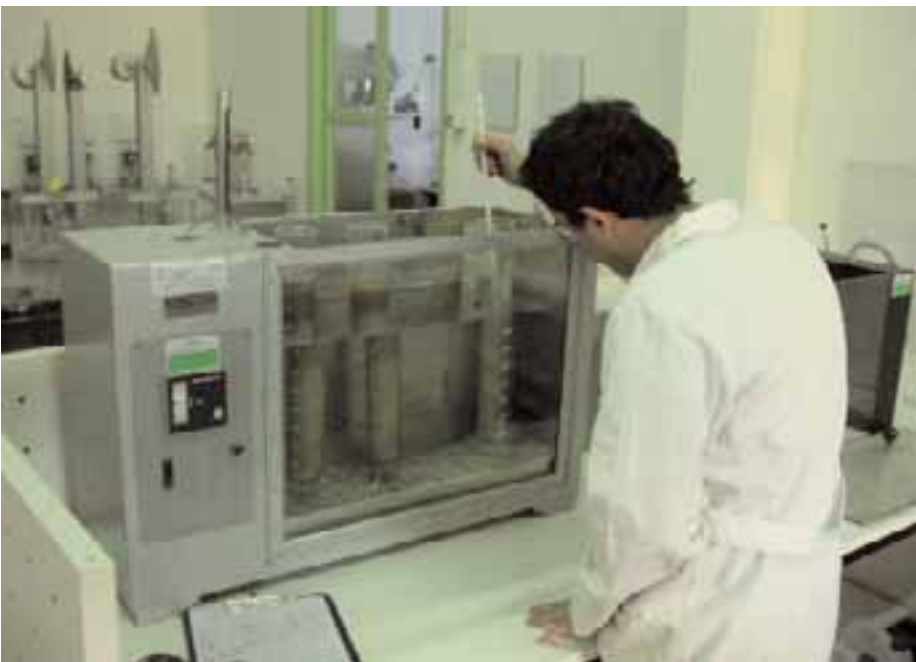
Figura 2.27 - L'analisi granulometrica delle frazioni di terreno minori di 0,075 mm è effettuata per sedimentazione (metodo aerometrico). Il passante al setaccio più piccolo è mescolato in acqua, ottenendo una sospensione che viene lasciata decantare. Misurando di tanto in tanto la densità della sospensione (con l'aerometro, in figura) e nota la legge di Stokes che determina la velocità di sedimentazione in funzione del diametro della particella, si ottiene il diametro delle particelle ancora in sospensione e quindi la ricostruzione della curva granulometrica dei fini
