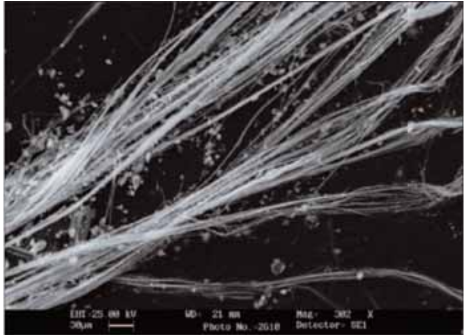
Figura 8.14 - Immagine al microscopio elettronico (SEM) di fibre di crisotilo
