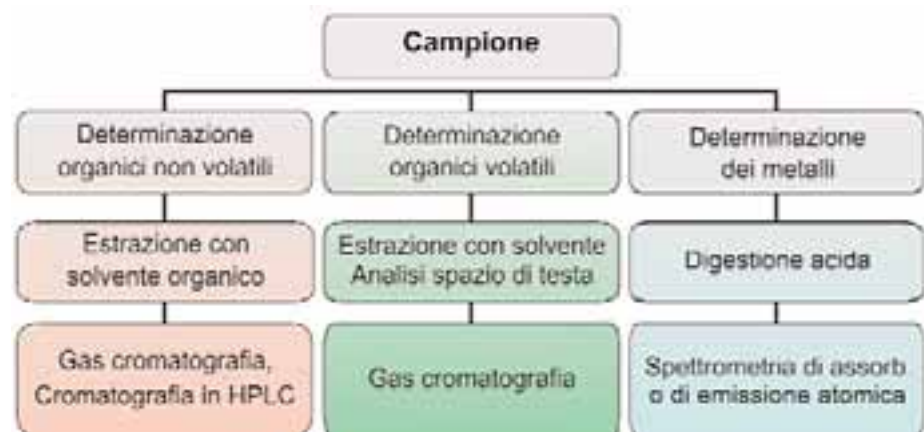
Figura 8.2 - Schema indicativo delle possibili procedure analitiche e delle tecniche strumentali comunemente impiegate per la determinazione delle specie chimiche di interesse ambientale
