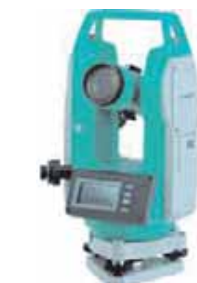
Figura 6.1 - Il teodolite è uno strumento ottico a cannocchiale per la misurazione degli angoli azimutali (sul piano orizzontale) e zenitali (sul piano verticale) usato per rilievi geodetici e topografici. Attualmente sono stati quasi completamente sostituiti dalla stazione totale, in cui al teodolite è accoppiato un distanziometro; lo stesso distanziometro può essere del tipo tradizionale e cioè ha bisogno del prisma riflettente per effettuare la misura distanziometrica oppure del tipo laser e rileva la distanza senza l'ausilio del prisma, molto utile in caso di punti inaccessibili.
