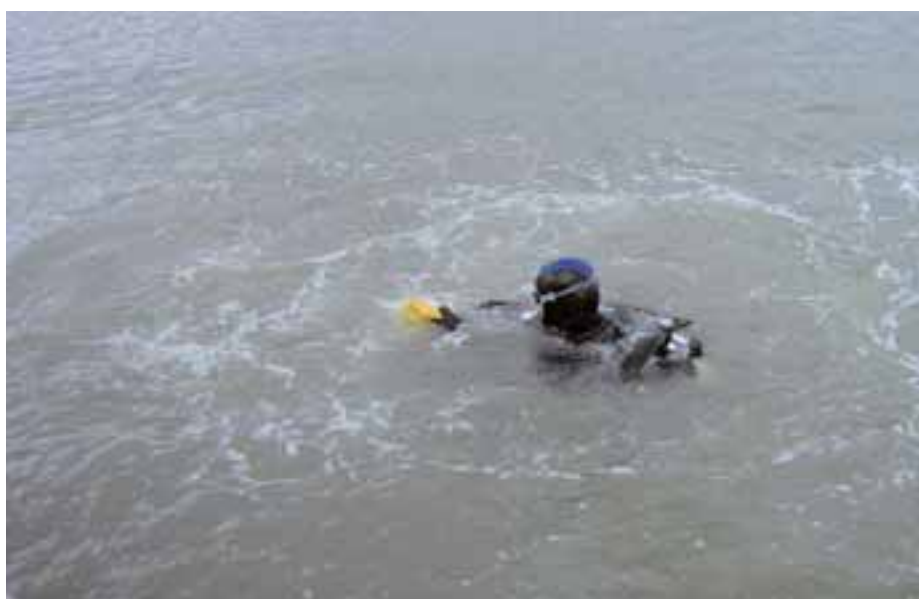
Figura 5.11 - Qualora il battente d'acqua sia nell'ordine di qualche decina di metri il prelievo del sedimento può anche essere effettuato manualmente da subacqueo munito di carotiere
