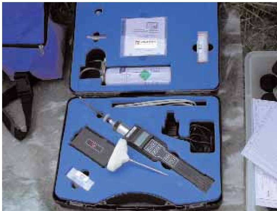
Figura 2.23 - Fotoionizzatore portatile (PID). La dotazione dello strumento è composta da filtri per trattenere l'umidità e le polveri e da bomboletta di gas (in genere isobutilene) per la taratura dello strumento
