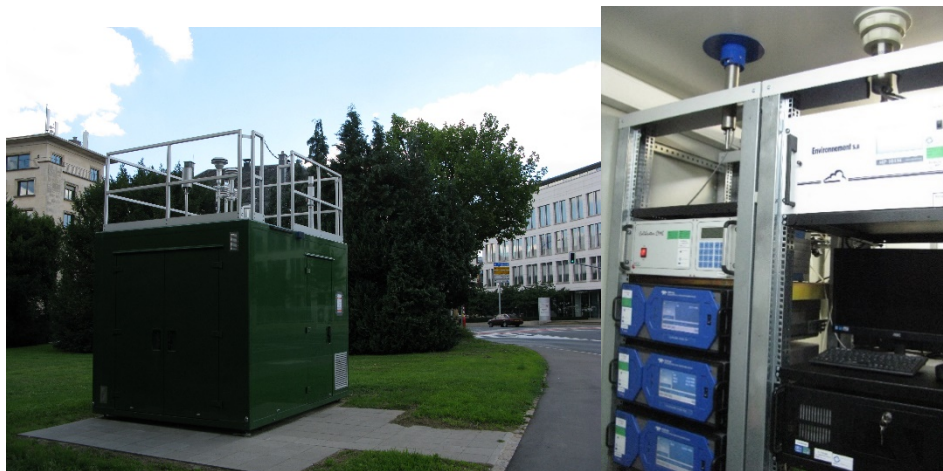
Stazione di monitoraggio della qualità dell'aria e punti di campionamento (dispositivi blu nell'immagine a destra)
