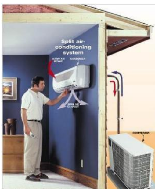
Figura 5.4 - Aria condizionata split: unità interna a parete e unità esterna (Fonte: UNEP Ozone Secretariat, Fact Sheets 8, 2015)
