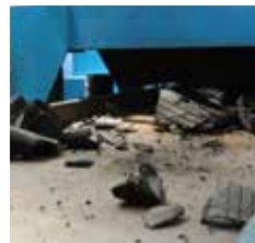
Cippato di gomma Dimensioni 20-50 mm
